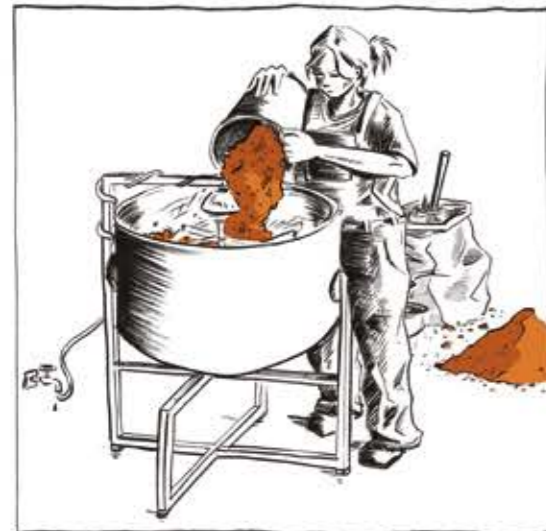
L'APPORT DE 15 À 35 % D'EAU PERMET D'OBTENIR UNE PÂTE VISQUEUSE. L'ADDITION DE SABLE ET/OU DE FIBRES VÉGÉTALES EST PARFOIS NÉCESSAIRE POUR ÉVITER LA FISSURATION.
